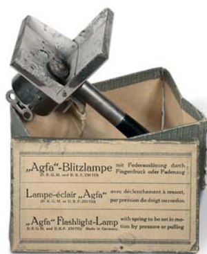
«AGFA»-BLITZLAMPE. ALEMANIA, 1909. ESTE POPULAR FLASH, QUE DURANTE BASTANTES AÑOS SE MANTUVO EN LAS ESTANTERÍAS DE LAS TIENDAS DE FOTOGRAFÍA, TIENE UN SOPORTE PLEGABLE PARA EL MAGNESIO Y LA IGNICIÓN LA PRODUCE UN MECANISMO DE CHISPA DE TIPO «MECHERO», QUE SE MUEVE POR UN RESORTE AL ACCIONAR UN CORDÓN, PUDIENDO ALEJAR DEL CUERPO LA ANTORCHA CON UNA MANO Y DISPARAR CON LA OTRA.
