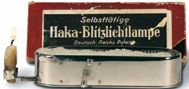
HAKA-BLITZLICHTLAMPE. ALEMANIA, HACIA 1910. TAMBIÉN ES UN FLASH DOTADO DE UN SISTEMA INGENIOSO PARA PROTEGER DE LA EXPLOSIÓN DEL MAGNESIO. CONSISTE EN UN MECANISMO RETARDADOR, MOVIDO POR RESORTE, QUE CUANDO SE DISPARA VA ACERCANDO UNA VELA ENCENDIDA AL SOPORTE DONDE ESTÁ COLOCADO EL POLVO DE MAGNESIO, PROVOCANDO EL FOGONAZO AL ALCANZARLE LA LLAMA.
