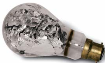
SASHALITE PHOTOFLASH BULB. FABRICADA POR LA GENERAL ELECTRIC CO. EN INGLATERRA EN 1930. EN SU INTERIOR SE ENCUENTRA UN FILAMENTO Y LÁMINAS DE ALUMINIO DE MEDIA MICRA DE ESPESOR EN UN AMBIENTE DE OXÍGENO A BAJA PRESIÓN. AL LLEGAR AL FILAMENTO UNA CORRIENTE SUMINISTRADA POR UNA PILA DE 4 V, SE PRODUCE LA DEFLAGRACIÓN INTERNA. ESTAS BOMBILLAS PERMITIERON COMENZAR A SINCRONIZAR LOS OBTURADORES A 1/50 DE SEGUNDO APROXIMADAMENTE.
