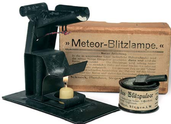
METEOR-BLITZLAMPE. FLASH ALEMÁN DE 1900 QUE FUNCIONA DE UNA FORMA SENCILLA, INGENIOSA Y EFICAZ EN ARAS DE LA SEGURIDAD DEL OPERADOR. EL MAGNESIO SE COLOCA EN UNA CUBETA ABATIBLE QUE SE ACCIONA A DISTANCIA MEDIANTE EL TIRÓN DE UN CORDONCILLO Y QUE CUANDO SE VIERTE EL MAGNESIO SOBRE LA LLAMA DE LA VELA ENCENDIDA PRODUCE LA DEFLAGRACIÓN. ESTE SISTEMA ALEJA A LAS MANOS DEL PELIGRO.
